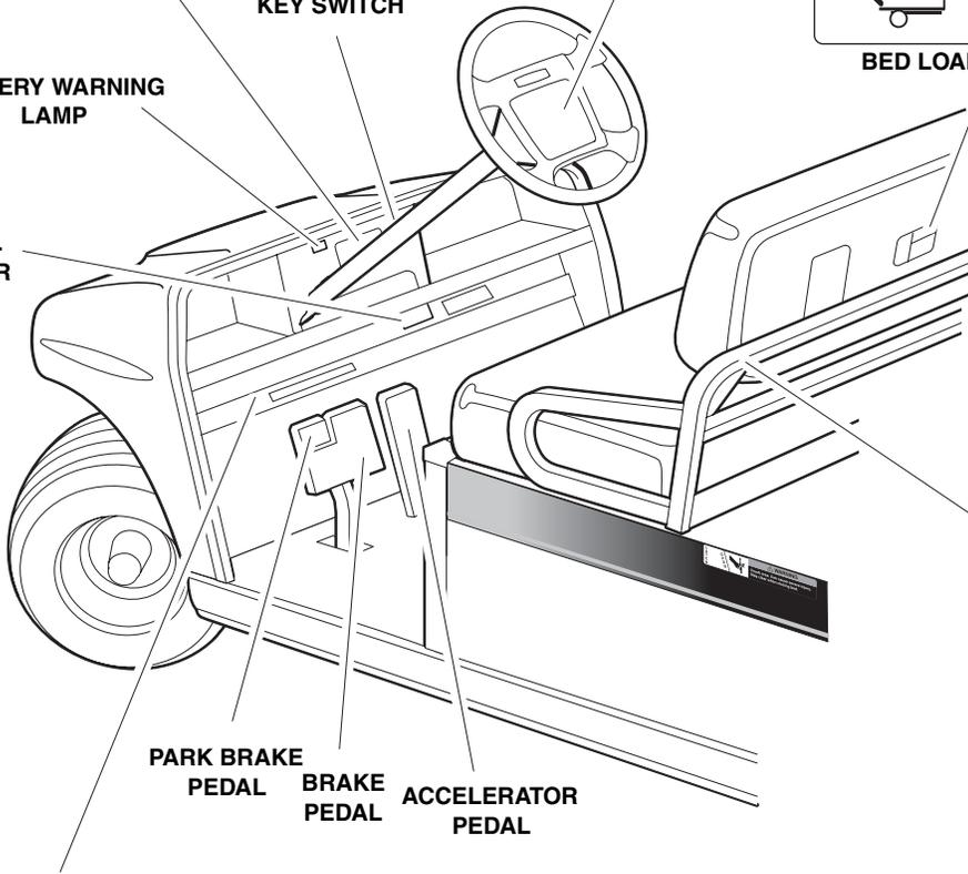
**PARK BRAKE PEDAL** **BRAKE PEDAL** **ACCELERATOR PEDAL**
