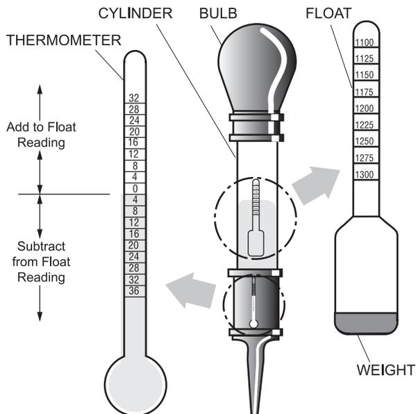
Fig. 7 Hydrometer
