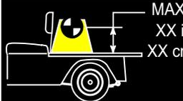
LOAD CENTER OF GRAVITY, MAXIMUM HEIGHT
